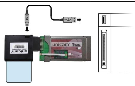
7.) Schieben Sie das CAM <u>vorsichtig</u> in den CI-Slot. <u>Achten Sie darauf, dass das Flachbandkabel sich nicht aus der Befestigung löst!</u> Die Service-LED sollte nun rot aufleuchten. Die verschlüsselten Sender sollten nun entschlüsselt werden.
