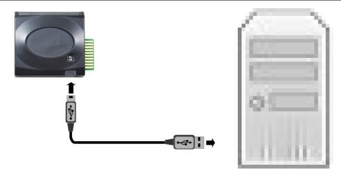
1.) Schließen Sie das Mini-USB-Kabel an das Kopfteil an. Stecken Sie das andere Ende an einen freien USB-Port Ihres Computers an. Es erscheint der Hardwaredialog für neue Hardware:
