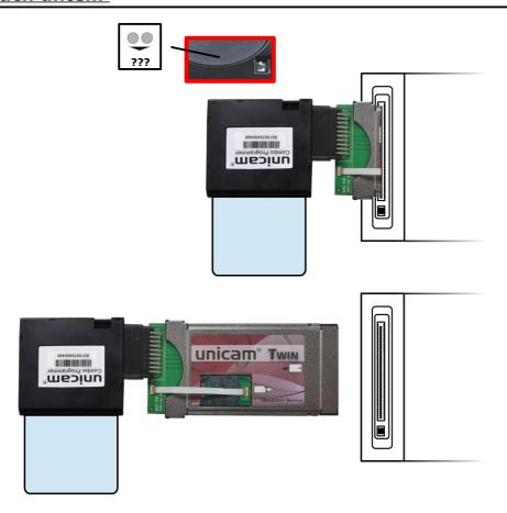
6.) Schließen Sie das Mini-USB-Kabel an den Programmer an. Stecken Sie das andere Ende an einen freien USB-Port Ihres CI-Geräts an (falls vorhanden). Alternativ kann auch ein anderes Gerät den Strom per USB bereit stellen.
