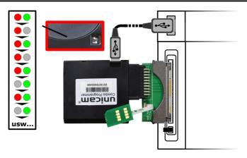
10.) Nachdem der Programmer die Programmierung beendet hat, leuchten die Service-LEDs abwechselnd auf. Ziehen Sie das USB-Kabel aus dem USB-Slot und das Modul wieder aus dem CI-Slot heraus und entfernen Sie den Programmer vom CAM. Ihr CAM ist nun einsatzbereit.
