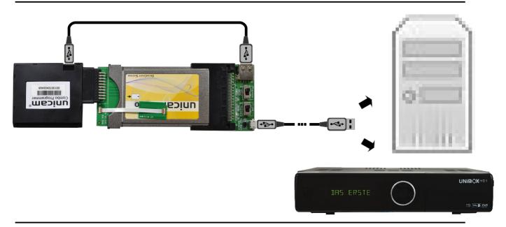
6.) Nachdem Sie das komplette Programmer-Set an die Stromquelle angeschlossen haben, schalten Sie nun den Programmer-Schalter auf "ON". Warten Sie 2-3 Sekunden bis die grüne und die rote Service-LED gleichzeitig blinken.
