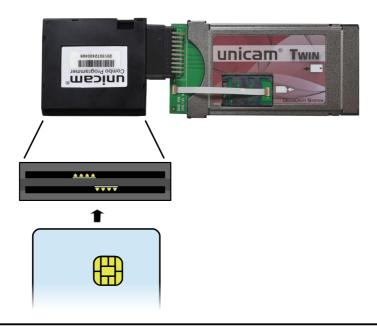
3.) Schieben Sie das CAM <u>vorsichtig</u> in den CI-Slot. <u>Achten Sie darauf, dass das Flachbandkabel sich nicht aus der Befestigung löst!</u>
