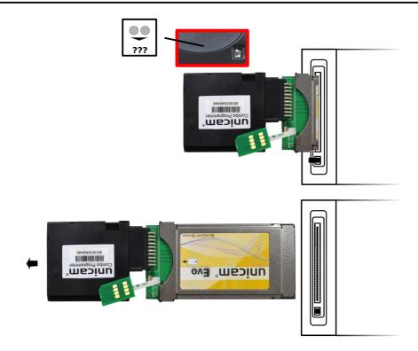
8.) Schließen Sie das Mini-USB-Kabel an den Programmer an. Stecken Sie das andere Ende an einen freien USB-Port Ihres CI-Geräts an (falls vorhanden). Alternativ kann auch ein anderes Gerät den Strom per USB bereit stellen.
