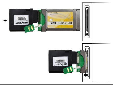
5.) Während des Programmiervorgangs leuchtet abwechselnd eine Service-LED permanent, die andere blinkt schnell. Dieser Vorgang kann bis zu mehreren Minuten dauern.
