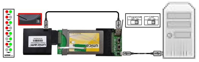
8.) Nachdem der Programmer die Programmierung beendet hat, leuchten die Service-LEDs abwechselnd auf. Stellen Sie den CAM- und den Programmer-Schalter auf dem Power-Board wieder auf "OFF".
