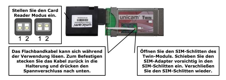
2.) Achten Sie darauf, dass Sie die Smartcard(s) mit dem Chip zur Innenseite zeigend einstecken (siehe Abbildung unten).
