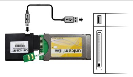
9.) Schieben Sie das CAM in den CI-Slot. Der Programmer beginnt selbstständig mit dem Programmiervorgang. Während des Programmiervorgangs leuchtet abwechselnd eine Service-LED permanent, die andere blinkt schnell. Dieser Vorgang kann bis zu mehreren Minuten dauern.
