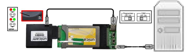
7.) Danach schalten Sie den CAM-Schalter auf "ON". Während des Programmiervorgangs leuchtet abwechselnd eine Service-LED permanent, die andere blinkt schnell. Dieser Vorgang kann bis zu mehreren Minuten dauern.
