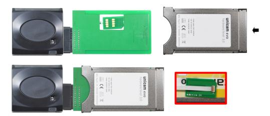
4.) Schalten Sie das Gerät mit dem CI-Slot ein. Schieben Sie das CAM in den CI-Slot. Der Programmer beginnt selbstständig mit dem Programmiervorgang.
