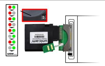
6.) Nachdem der Programmer die Programmierung beendet hat, leuchten die Service-LEDs abwechselnd auf. Ziehen Sie das Modul wieder aus dem CI-Slot heraus und entfernen Sie den Programmer vom CAM. Ihr CAM ist nun einsatzbereit.
