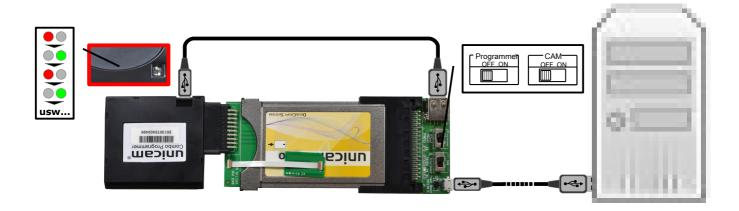
9.) Sie können nun das Programmer-Set von der USB-Stromquelle abziehen und den Programmer und das Power-Board vom CAM entfernen. Ihr CAM ist nun einsatzbereit.
