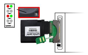
7.) Sollten die Service-LEDs nicht oder nur kurz aufleuchten, kann es sein, dass Ihr Gerät über den CI-Slot nicht den nötigen Strom liefert, um den Programmer zu versorgen. Hierfür müssen Sie dem Programmer zusätzlichen Strom über den Mini-USB-Anschluss zur Verfügung stellen. Ziehen Sie das Modul wieder aus dem CI-Slot heraus.
