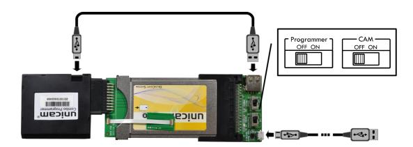
5.) Schließen Sie das Micro USB-Kabel an den USB-Anschluss eines beliebigen Geräts **direkt** an (z.B. PC, Receiver, usw...). Das Gerät muss lediglich die Stromversorgung über USB gewährleisten. Achten Sie daher darauf, dass das Gerät dementsprechend eingeschaltet ist.
